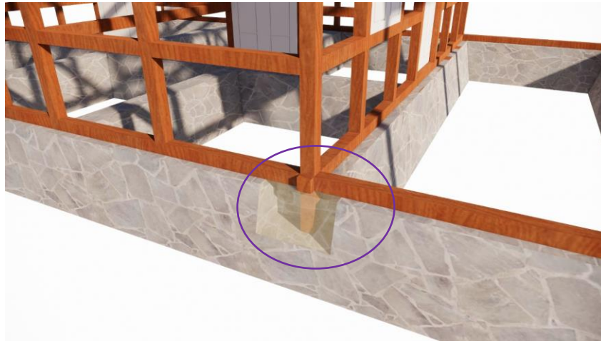
Gambar 4: Tampak kolom yang menerus ke dalam pondasi sekira 60 Cm
