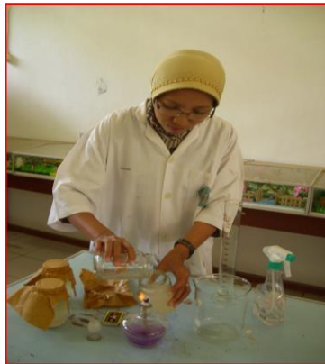
Gambar 10 Inokulasi stater Nata pada air kelapa
