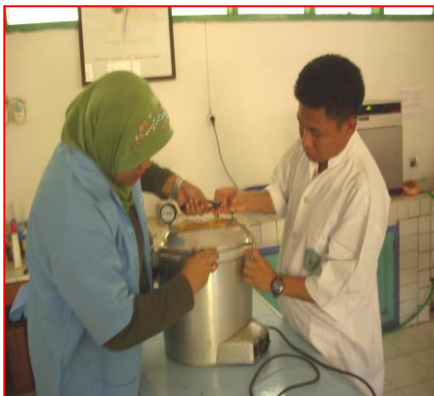
Gambar 15. Autoklaf untuk sterilisasi
