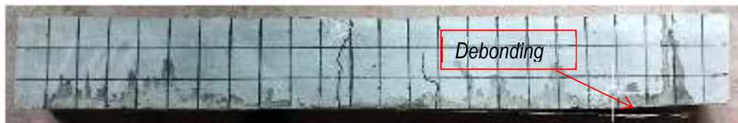
Gambar 4. 13 Pola Retak Balok CFRP (B- FRP2 )
