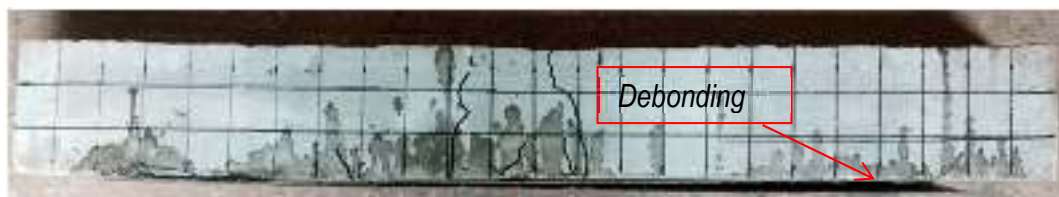
Gambar 4. 12 Pola Retak Balok CFRP (B- FRP 1)
