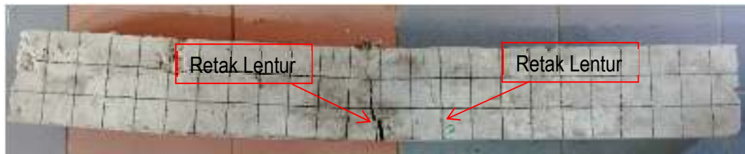
Gambar 4. 11 Pola Retak Balok Variasi 2 (BVP 2)
