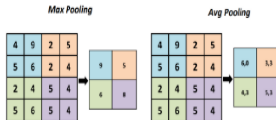
Gambar 2. 17. Max pooling dan average pooling (Saputra, 2022).
