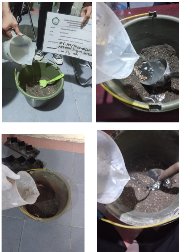
Mencampur Larutan Aktivator Dengan Campuran Fly Ash dan Pasir Batu Apung
