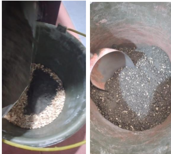
Mencampur Larutan Aktivator Dengan Campuran Fly Ash dan Pasir Batu Apung
